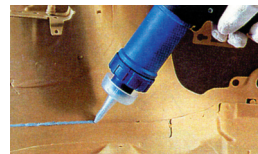
Nakładanie pasma masy uszczelniającej Zamknąć całkowicie regulator wytłaczania (niebieska śruba regulacyjna), dyszę rzyżożyć skośnie do powierzchni i równomiernie przesuwając. Bezwzględnie należy unikać zamknięcia dyszy wskutek przyłożenia pod kątem prostym. W takim przypadku medium znajdujące się między dyszą materiałową a powietrzną może przedostać się do tylnej części pistoletu i uszkodzić go.
